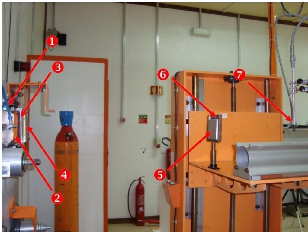
Figura 2. Montagem experimental utilizada na determinação dos HVL's para caracterizar as qualidades de radiação RQR, do LMRI: 1) Ampola de Raios X; 2) Obturador; 3) Filtração adicional de alumínio; 4) Colimador de chumbo de diâmetro fixo 1,6 cm; 5) Placas atenuadoras de alumínio; 6) Colimador de chumbo de diâmetro fixo 2 cm; 7) Câmara de Ionização.
