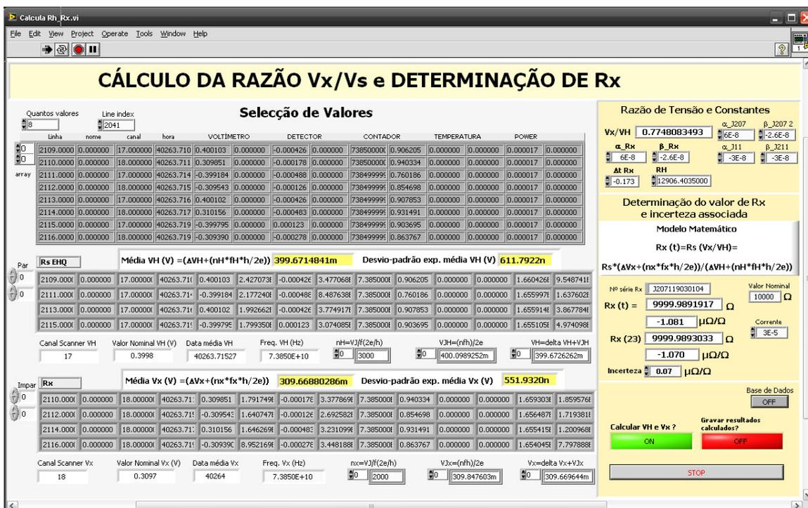
Figura 2 - Painel frontal do módulo aplicativo para a determinação de valores experimentais e correspondentes incertezas de resistências-padrão convencionais com o método potenciométrica de Josephson.
